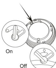
1.2 Fixez l'alarme au support de montage et tournez dans le sens des aiguilles d'une montre pour la verrouiller en place.
